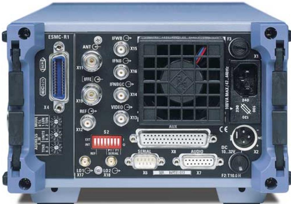
ESMC-Rückseite; die IEC-Bus-Schnittstelle kann optional ersetzt werden durch RS232 + RS422/RS485
